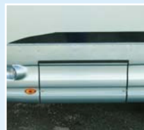
41 Schließfach für den Generator - Schließfach hinten mit genügend Platz für den Generator. Gewicht: 38 kg
